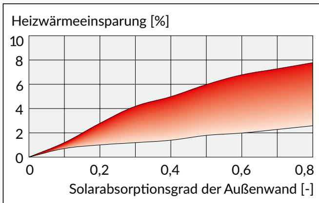
Bild 2.1: Heizwärmeeinsparung durch Solarabsorption auf Außenoberflächen gemäß [L5]
