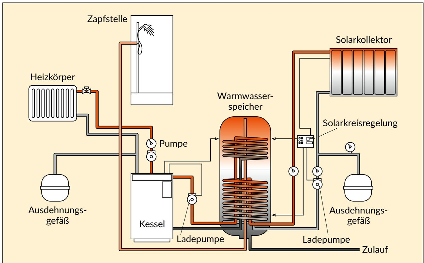
Bild 7.1: Strangschema einer Warmwasser-Zentralheizung mit gekoppelter Trinkwassererwärmung und thermischer Solaranlage
