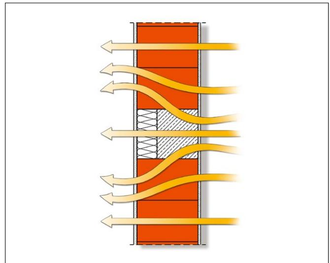
Bild 5.2: Wärmestromverlauf in einem aus zwei nebeneinander liegenden Bereichen zusammengesetzten Außenbauteil
