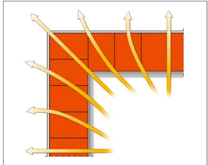
Bild 5.1: Wärmestromverlauf durch eine zweidimensionale, monolithische Außenwanddecke
