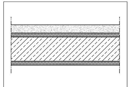
**Tabelle 4.16:** U-Werte von Bodenplatten auf Erdbreich aus Stahlbeton mit 5 cm schwimmendem Zementestrich
