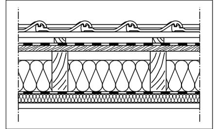
**Tabelle 4.11:** U-Werte im Sparren-/Gefachbereich von Dächern mit Vollsparrendämmung, raumseitig ist eine 12,5 mm dicke Gipskartonplatte angenommen
