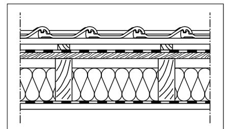
Die Sparrenabstände liegen in der Regel zwischen  $60$  und  $75 \text{ cm}$ . Die Sparrenbreiten liegen normalerweise zwischen  $6$  und  $10 \text{ cm}$ . Somit ergeben sich die prozentualen Anteile Sparren/Gefach zwischen  $10/90$  und  $15/85 \%$ .
