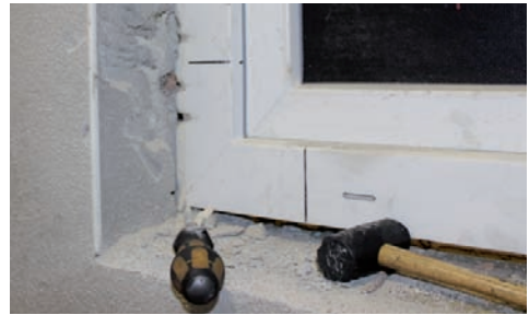
Beschädigungen nach mechanischem Angriff auf Fenster der Widerstandsklasse RC 2: → Bild oben: Rechte Laibungsseite ohne Armierungsputz mit Gewebeeinlage; → Bild unten: Linke Laibungsseite mit Armierungsputz mit Gewebeeinlage
