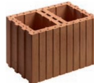
Schallschutz-Füllziegel für Wohnungs- / Haustrennwände zum Verfüllen mit fließfähigem Beton C12/15, Körnung 0-16 mm mit oder ohne Vertikalbewehrung R_{w,2} = 56,9 dB ( t = 17,5 cm) R_{w,2} = 60,8 dB ( t = 24 cm) R_{w,2} = 63,6 dB ( t = 30 cm)
