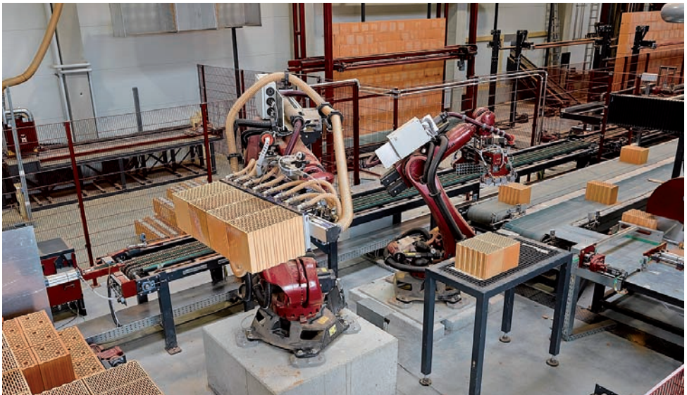
Vollautomatisierte Produktionsanlage zur Vorfertigung von geklebten Ziegel-Wandelementen
