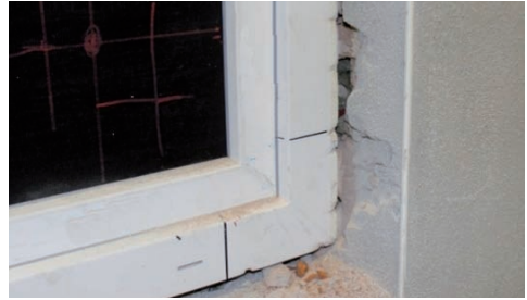
Beschädigungen nach mechanischem Angriff auf Fenster der Widerstandsklasse RC 2: → Bild oben: Rechte Laibungsseite ohne Armierungsputz mit Gewebeeinlage; → Bild unten: Linke Laibungsseite mit Armierungsputz mit Gewebeeinlage
