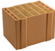
Füllung: Mineralfaserdämmplatten \lambda = 0,08 / 0,09 / 0,10 \text{ W/mK} R_w^{(1)} = 49,9 / 50,0 / 51,3 \text{ dB} f_k = 3,9 / 4,6 / 3,0 \text{ MN/m}^2 (SFK 12)
