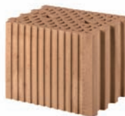
Erdbebensicheres Bauen und bei besonders hohen Anforderungen an die Tragfähigkeit, z. B. Innenwand Rohdichteklasse 1,4 f_k = 10,2 MN/m 2 (bei SFK 20) \lambda = 0,58 W/mK Wanddicken t = 17,5 cm
