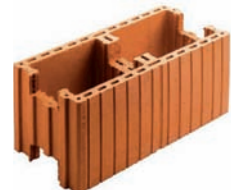
Schalungsziegel für Wohnungs- / Haustrennwände zum Verfüllen mit fließfähigem Beton C12/15, Körnung 0-16 mm mit oder ohne Horizontal- / Vertikalbewehrung R_{w,2} = 57 dB ( t = 17,5 cm) R_{w,2} = 61,4 dB ( t = 24 cm) R_{w,2} = 64,4 dB ( t = 30 cm)
