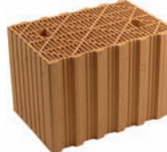
ungefüllt \lambda = 0,12 \text{ W/mK} R_w^{(1)} = 49 \text{ dB} (bei 36,5 cm) f_k = 4,0 \text{ MN/m}^2 (bei SFK 12)
