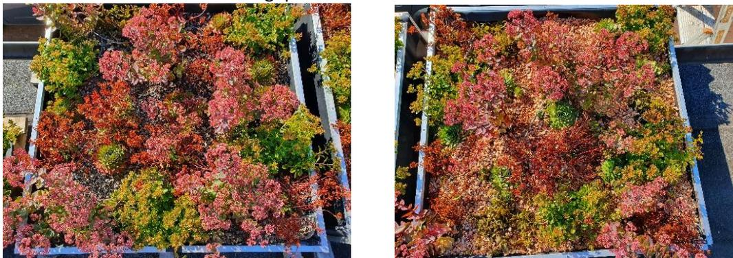
Abb. 1: Vergleichende Freilandversuche (links: Handelsware, rechts: Ziegelgranulat)
